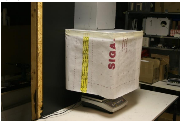
Abbildung 3: Versuchsaufbau mit Schirm zur Bestimmung eines Erfassungsgrades 100 % Erfassungsgrad [PHI]
