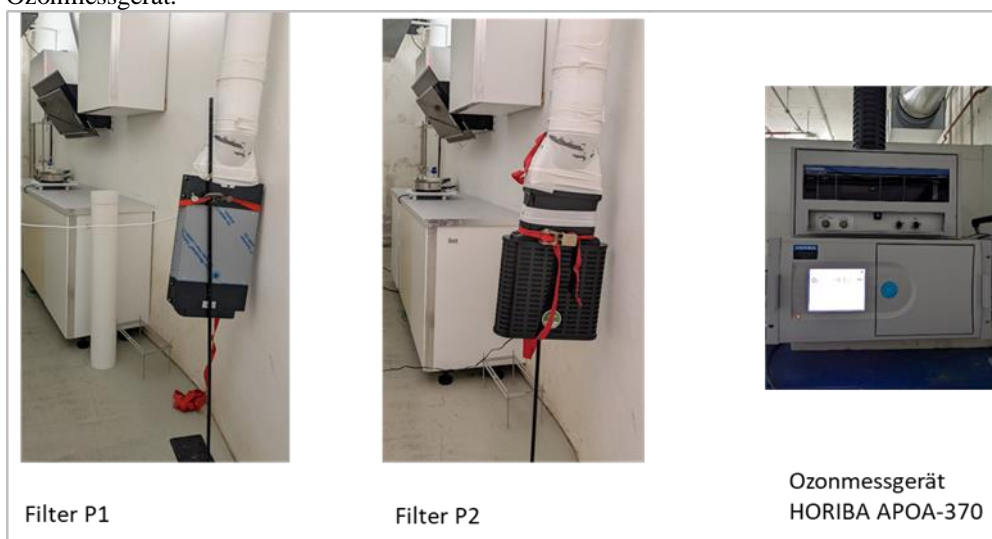
Abbildung 49: Versuchsanordnung zur Bestimmung der Geruchsreduzierung – Plasmafilter [IHD GmbH]
