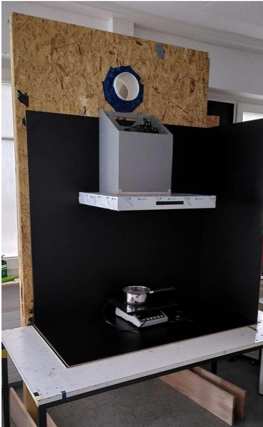
Abbildung 2: Frontalaufnahme Versuchsaufbau, Abgasrohr nicht verbunden [PHI]
